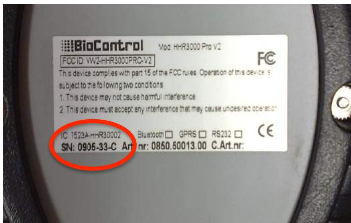
På bildet over kan du se en håndleser versjon "C". Hvis du ikke har en bokstav her, eller har bokstav "A" eller "B", så må håndleseren sendes inn til BioControl for oppgradering før du kan ta i bruk HHR Animalia. Ta kontakt med oss på [post@biocontrol.no](mailto:post@biocontrol.no) for mer informasjon.
